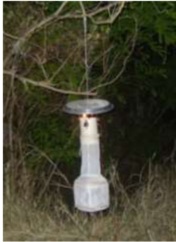
Figura 1. Armadilha luminosa do tipo CDC (Centers for Disease Control) convencional, utilizada na captura de insetos.
