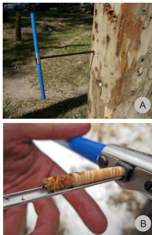
Figura 2. A) Amostragem de coleta do incremento de madeira; B) Incremento de madeira saindo do equipamento de coleta.
