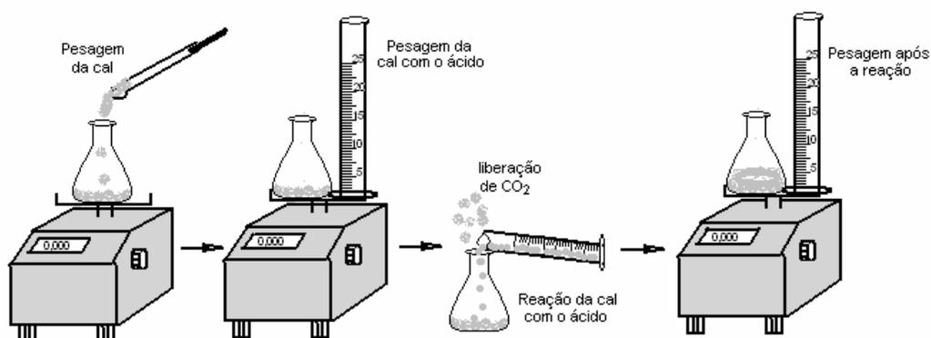
Figura 4 Determinação de CO<sub>2</sub>
